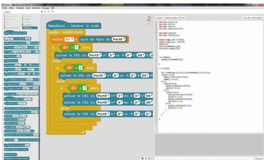
Ce logiciel basé sur Scratch permet de programmer la gamme Makeblock (technologie Arduino). Le programme créé avec des blocs est automatiquement converti en langage Arduino, il peut être envoyé directement dans l'IDE Arduino. mBlock peut être également utilisé afin de piloter des cartes standards Arduino UNO et Leonardo.
